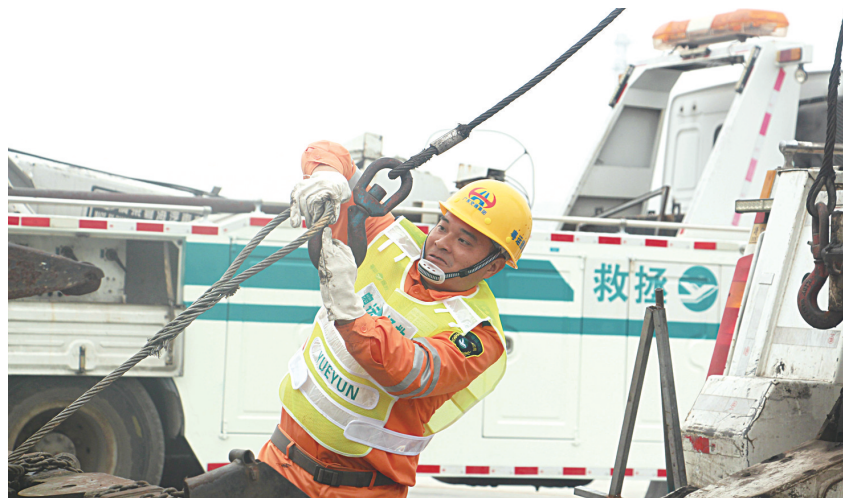
■参赛职工进行钢丝绳挂扣与牵引绳连接
