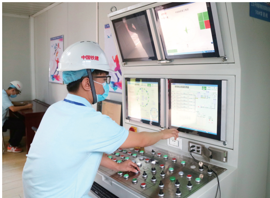
■选手在盾构机仿真模拟操作室调整刀盘转速等盾构掘进参数
